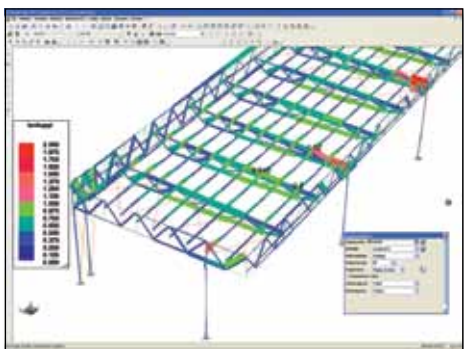
La rappresentazione grafica degli indici di resistenza sintetizza il risultato della verifica; le sezioni fuori norma sono eventualmente evidenziate con tonalità rossastre.
