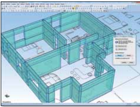
La modellazione di strutture murarie con gusci è facilitata da appositi strumenti di riconoscimento della geometria da disegno DXF/DWG, forometrie incluse. La congruenza della mesh viene garantita da specifiche procedure automatiche.
